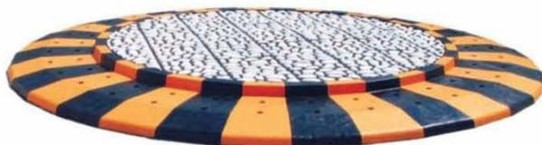
Rotatorie con Ø esterno da mt 5,10 a mt 40 realizzate con elementi modulari in pvc riciclato e riciclabile h cm 100 di facile installazione e rimozione. Gli elementi possono essere nero naturale oppure di colore giallo, bianco o rosso verniciati con speciali vernici per segnaletica orizzontale. L'installazione avviene tramite il fissaggio al piano stradale con appositi tasselli. Peso medio dei moduli (variabile in funzione del Ø esterno) Kg 35/40.
